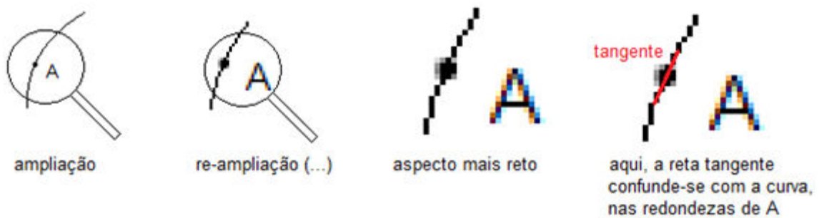
Figura 6: A reta tangente a um ponto numa curva é a reta suporte ao segmento definido pelas região imediatamente ao redor do ponto
